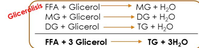
La **glicerólisis enzimática** es un proceso por el cual podemos obtener MAG, DAG y TAG a partir de un ácido graso (FFA), utilizando la glicerina como aceptor. Como catalizador se utiliza una enzima denominada lipasa. Se consiguen con este proceso aceites de baja acidez. Con el proceso de glicerólisis enzimática se consigue una reducción de la acidez libre.
